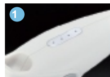
Indicatori led stato batteria
